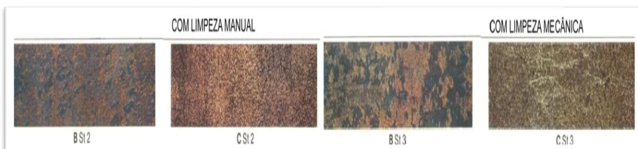
Figura 4.4 – Aspecto Após Limpeza conforme, norma sueca SIS 05 5900:1967
