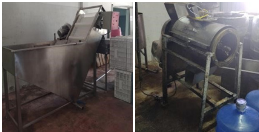
Figura 4 | Equipamento responsável pela lavagem e descascamento das frutas.
